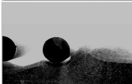
شکل ۱۷- الگوی آبشستگی در اطراف لوله‌های موازی با فاصله برابر قطر لوله از همدیگر
