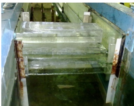
شکل ۵- نحوه مهار مدل موج شکن در فلوم آزمایشگاهی
