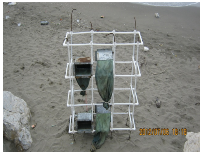
شکل ۱- تله گیر رسوب مورد استفاده در تعیین نرخ انتقال رسوب در ساحل شهر نور
