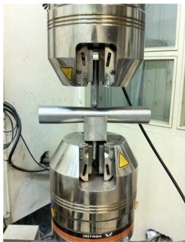
شکل ۴: نمایی کلی از اعمال قرشدگی در آزمایشگاه
