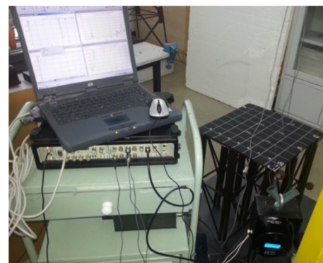
شکل ۱- چیدمان تجهیزات انجام آزمایش آنالیز مودال تجربی
