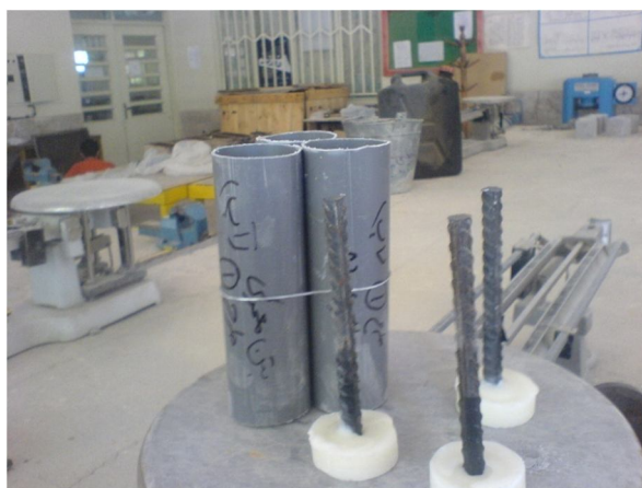
شکل ۵- نمونه‌های ساخته شده از استوانه‌های ۱۵×۶ سانتیمتر جهت آزمایش خوردگی
