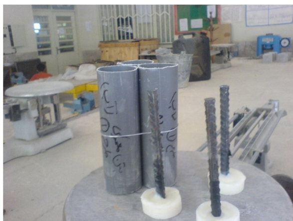
شکل ۵- نمونه‌های ساخته شده از استوانه‌های ۱۵×۶ سانتیمتر جهت آزمایش خوردگی
