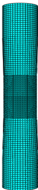
شکل ۶- نحوه مش‌بندی نمونه مدل‌سازی شده
