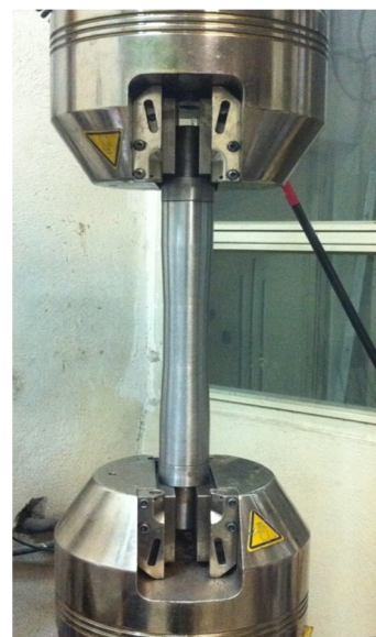
شکل ۲- نمایی کلی از آزمایش یک سوپه فشاری
