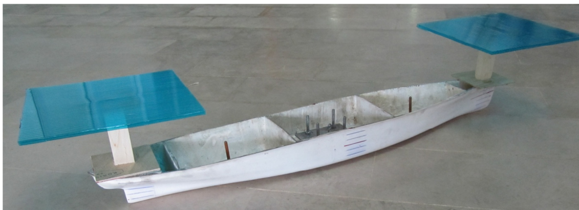
شکل ۳- تصویر مدل سری ۶۰ با ضریب ظرافت بدنه ۰/۶
