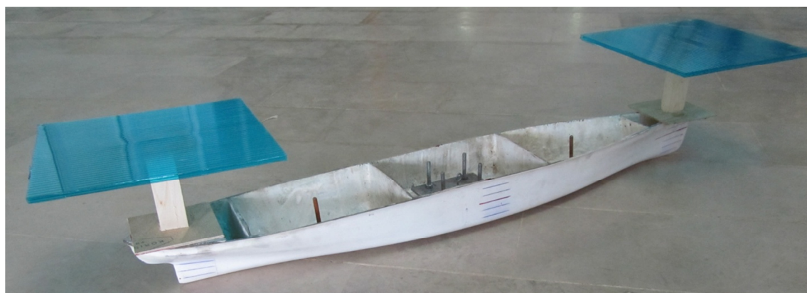
شکل ۳- تصویر مدل سری ۶۰ با ضریب ظرافت بدنه ۰/۶
