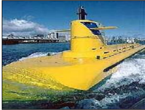
شکل ۱- زیردریایی توریستی V48، طول: 42.8ft، ظرفیت: ۴۸ نفر
