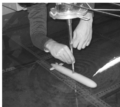
شکل ۹- نصب مدل بر روی ارابه حوضچه کشش
