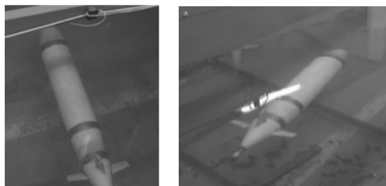
شکل ۱۹- زیرسطحی SUT-2 در حال مانور در حوضچه مرکز پژوهشی مهندسی دریا
