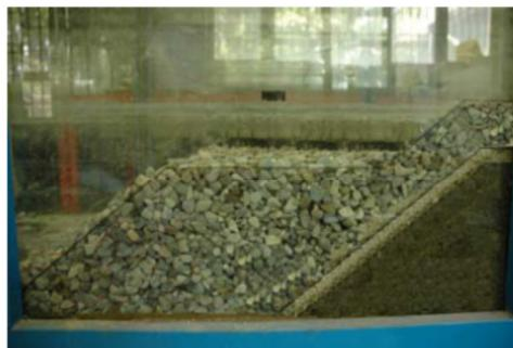
شکل ۴- نمایی از مصالح آرمور و فیلتر و هسته اجرا شده جهت ساخت مدل موج شکن سکویی
