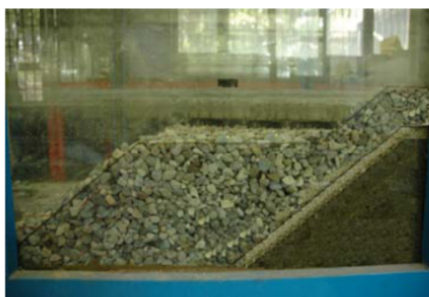
شکل ۴- نمایی از مصالح آرمور و فیلتر و هسته اجرا شده جهت ساخت مدل موج شکن سکویی
