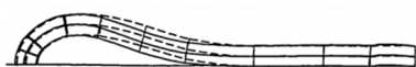
شکل ۱۰- مقایسه تغییر شکل نهایی مقطع عرضی در حالت شبه استاتیکی و دینامیکی ----- حالت شبه استاتیکی ————— حالت دینامیکی
