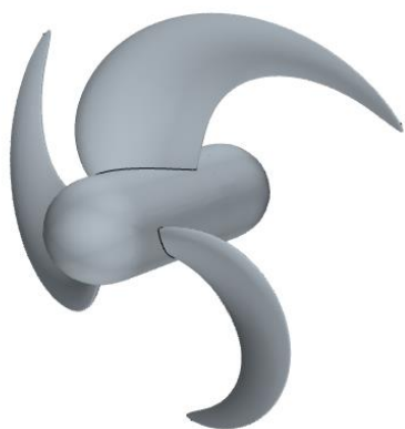
شکل ۱۲ نمایی از پروانه اسکيو بالا بدست آمده از بهينه سازی هيدروآکوستيکی و هيدروديناميکی
