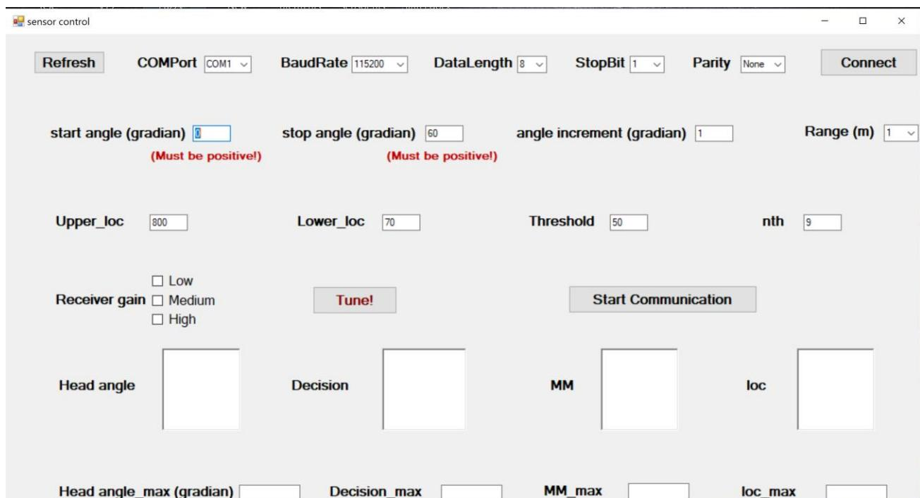
شکل ۱۷- نرم افزار رابط کاربری GUI برای پیکربندی و استخراج اطلاعات حسگر سونار
