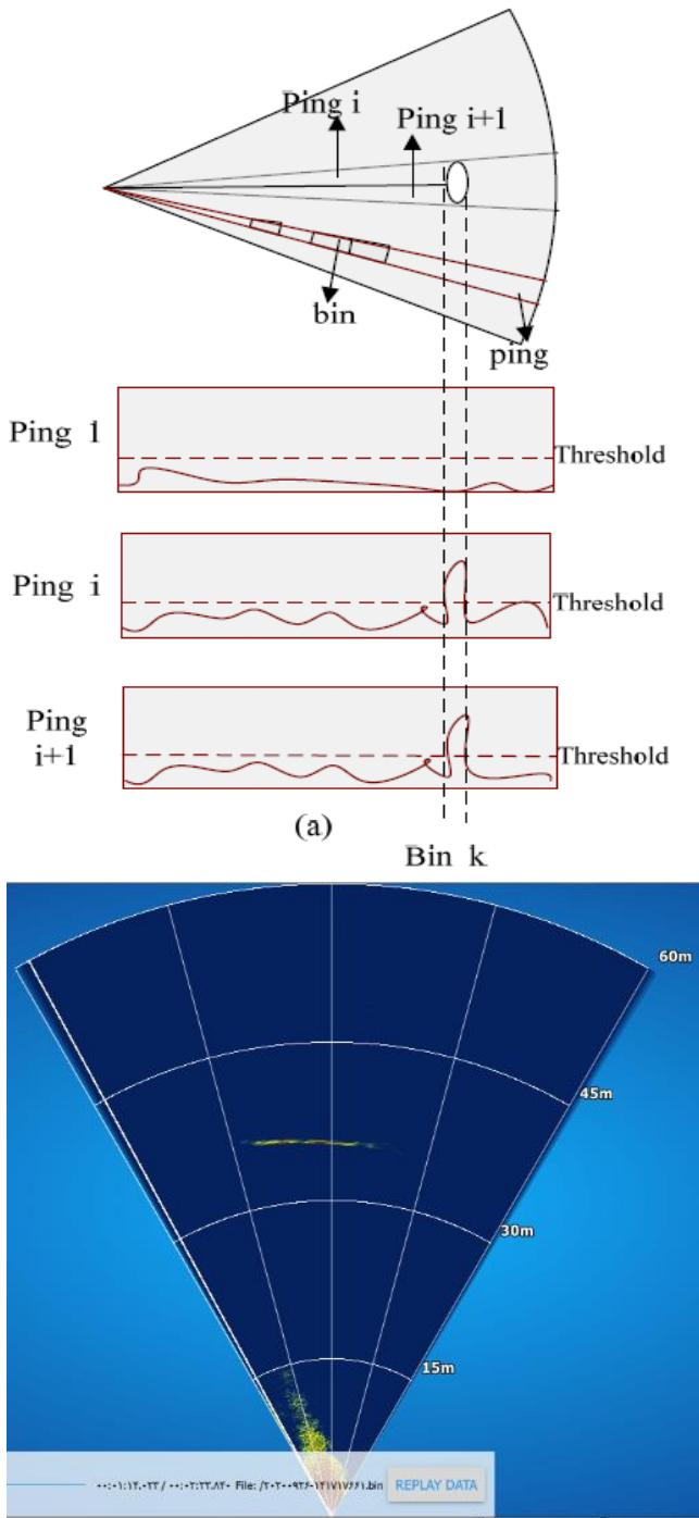
شکل ۵- بازخورد پژواک از اشیا و تشکیل تصویر آکوستیکی
