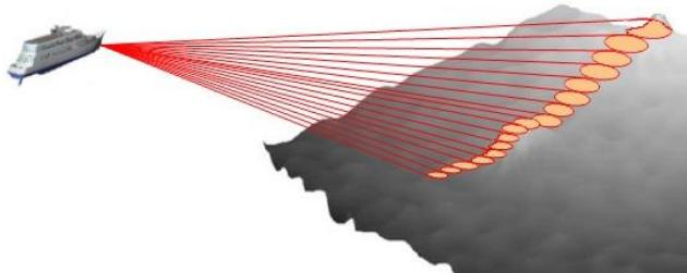
شکل ۱- مدل چند اشعه‌ای سونار [۲]
