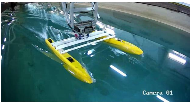
شکل ۱۴ - نمایی از تست مدل با وزن ۲۰ kg در سرعت ۲٫۵ m/s
