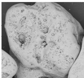
شکل ۱. تصویر میکروسکوپ الکترونی ماسه کربناته کیش
