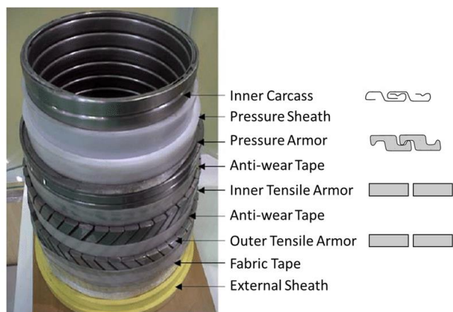
شکل ۱ لایه بندی رایزرهای انعطاف‌پذیر [۵]
