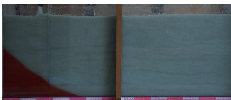
شکل ۵- گوه آب شور در مدل آزمایشگاهی هنگام استفاده همزمان دیوار آببند و چاه برداشت با دبی استخراج ۰/۰۶۵ لیتر بر دقیقه در شرایط پایدار.
