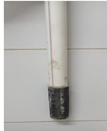
شکل ۳- تصویری از چاه برداشت از جنس لوله پی‌وی‌سی.
