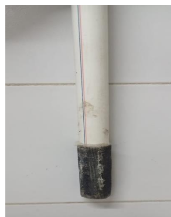
شکل ۳- تصویری از چاه برداشت از جنس لوله پی.وی.سی.
