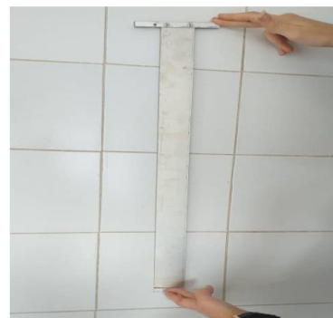
شکل ۲- ورق آلومینومی استفاده شده به عنوان مانع فیزیکی.
