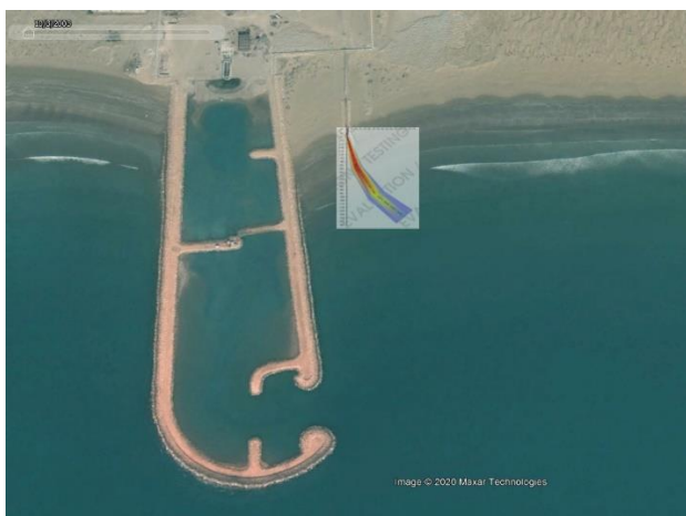
شکل ۸- الگوی پخش شوری برای دبی ۳ متر مکعب بر ثانیه با سرعت جریان ۰/۰۵۷ متر بر ثانیه
