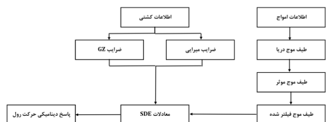
شکل ۲- روند محاسبه پاسخ دینامیکی حرکت رول کشتی در امواج نامنظم
