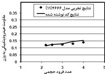
شکل ۵- مقایسه بین نسبت مقاومت به وزن شناور B برای کد استفاده شده و نتایج تجربی
