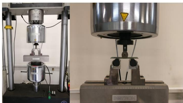
شکل ۵- تست خمش سه نقطه‌ای در دستگاه تست لمینیت‌ها
