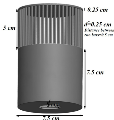
شکل ۲- جانمایی کلاهک آبیگر در کف تانک آزمایش و ابعاد سازه مدل آبیگر مورد مطالعه در این تحقیق (در مقیاس ۱:۴۰)
