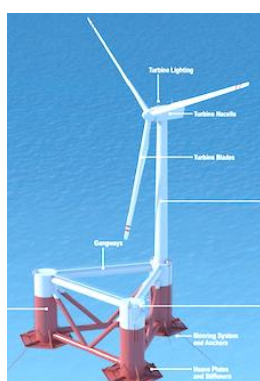
شکل ۱- ورق‌های هیو در پاشنه ستون‌های سکوی نیمه شناور یک توربین فراساحلی [۵]
