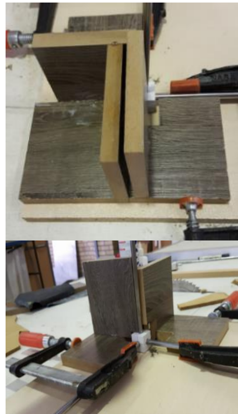
شکل ۱۸- ابزار ساخته شده برای گونیا کردن میله‌های المان کالیبراسیون سه بعدی در سه جهت
