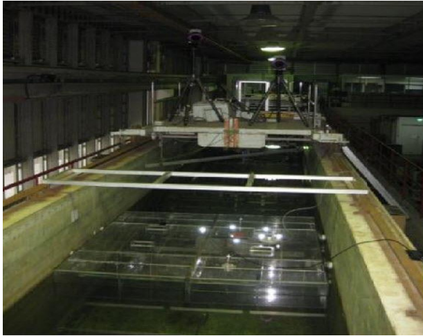
شکل ۱۱ - نمایی از موج‌شکن شناور به همراه مارکرها و دوربین اینفرارد [۱۰]
