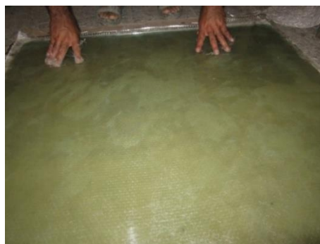
شکل ۴- گذاشتن شیشه رویی پس از اتمام لایه‌گذاری.
