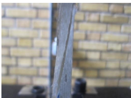
شکل ۱۵- نحوه شکست نمونه‌ها با شیب \frac{1}{6}
