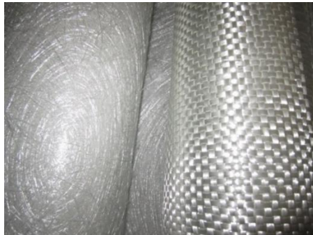
شکل ۳- لایه حصیری و رندم برای لایه‌چینی
