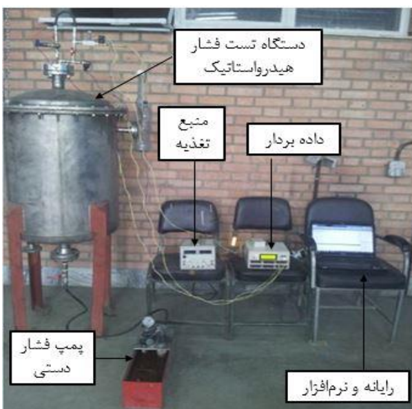
شکل ۱۰- نمای کلی از دستگاه و متعلقات آزمایش کمانش غیر مخرب هیدرواستاتیک خارجی
