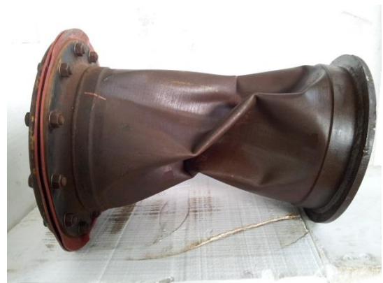
شکل ۱۸- نمونه فولادی بعد از پس کمانش
