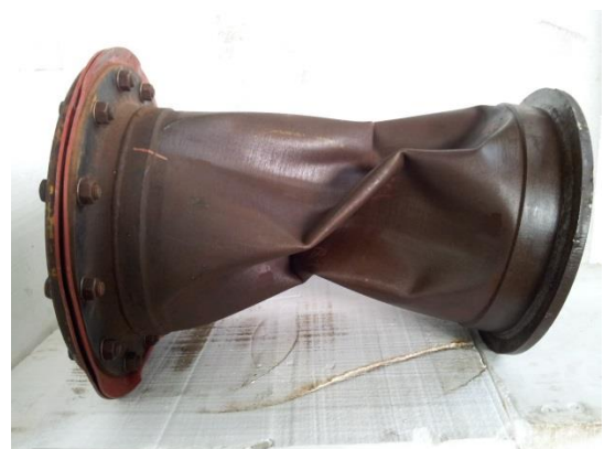
شکل ۱۸- نمونه فولادی بعد از پس کمانش
