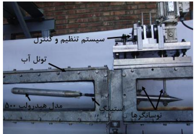
شکل ۳- تجهیزات نصب شده در تونل آب جهت انجام تست های دینامیکی و استاتیکی
