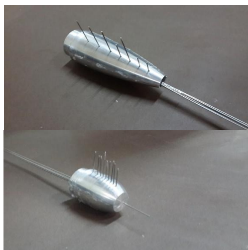
شکل ۷- نمایشی از دماغه و دم مدل با لوله‌های فشار
