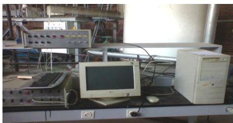
شکل ۱۱- سامانه داده برداری فشار، دما و دبی جریان
