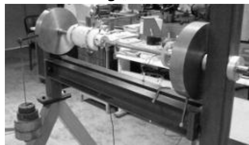
شکل ۱۷ - بارگذاری استاتیکی به منظور کالیبراسیون استاتیکی
