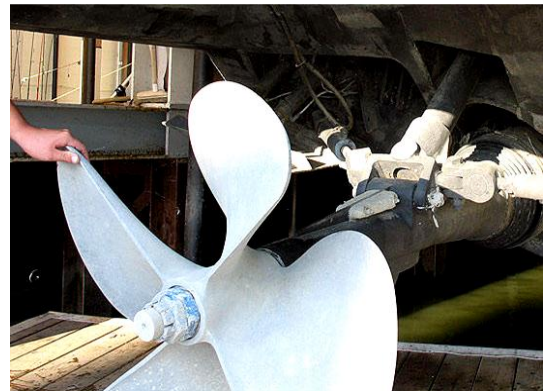
ب) هندسه واقعی یک نمونه پروانه نیمه مغروق شکل ۱- هندسه پروانه نیمه مغروق بصورت شماتیک و واقعی
