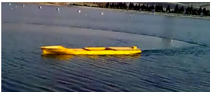
شکل ۴: مدل شناور KCS در حین تست مانور دور زدن در دریاچه
