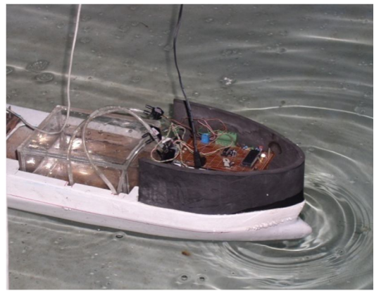
شکل ۸- مدل شناور در آزمایش اسلاشینگ؛ حسگرهای فشار به بورد الکترونیکی و از سمت دیگر به مخزن وصل شده اند.
