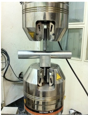
شکل ۴: نمایی کلی از اعمال قرشدگی در آزمایشگاه
