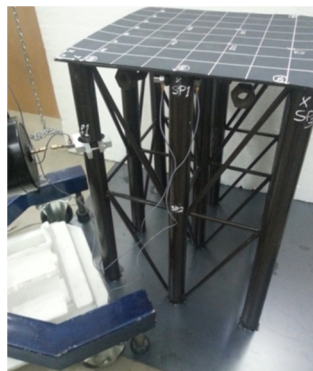
شکل ۲- شبکه‌بندی متناظر مدل فیزیکی و مدل عددی تهیه شده در نرم‌افزار ANSYS
