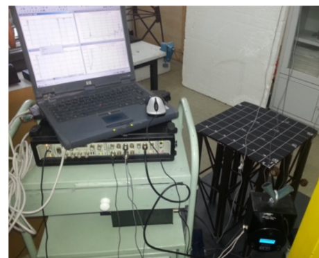
شکل ۱- چیدمان تجهیزات انجام آزمایش آنالیز مودال تجربی
