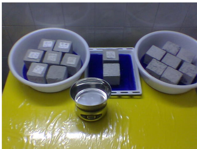
شکل ۱: قرار دادن نمونه‌های مکعبی داخل آب جهت تعیین جذب آب موئینه
