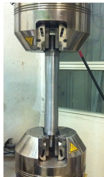
شکل ۲- نمایی کلی از آزمایش یک سوپه فشاری
