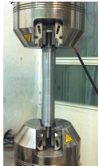
شکل ۲- نمایی کلی از آزمایش یک سوپه فشاری
