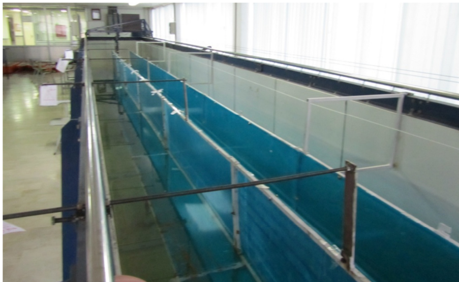
شکل ۱: نمایی از حوضچه و دیواره کاذب
