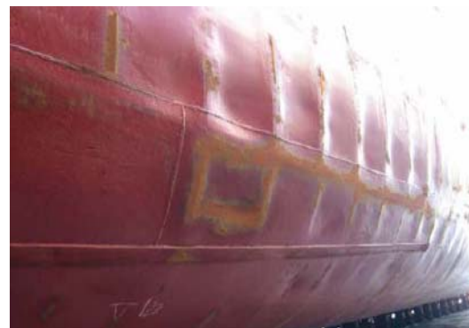
شکل ۲- نمونه‌ای واقعی از تغییر شکل‌های اولیه در محل ورق خن کشتی
