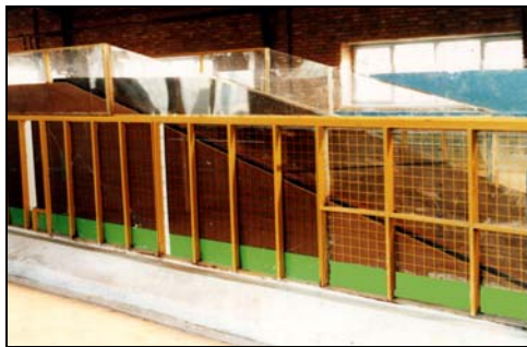
شکل ۱- الف- ابعاد انتخابی برای بدنه و پاشنه خاکریز، و ب- شمایی از خاکریز ساحلی ساخته شده در فلوام آزمایشگاهی
