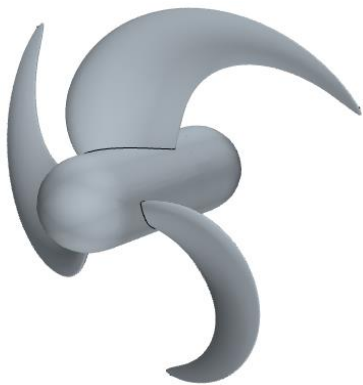
شکل ۱۲ نمایی از پروانه اسکيو بالا بدست آمده از بهينه سازی هیدروآکوستيکی و هیدروديناميکی
