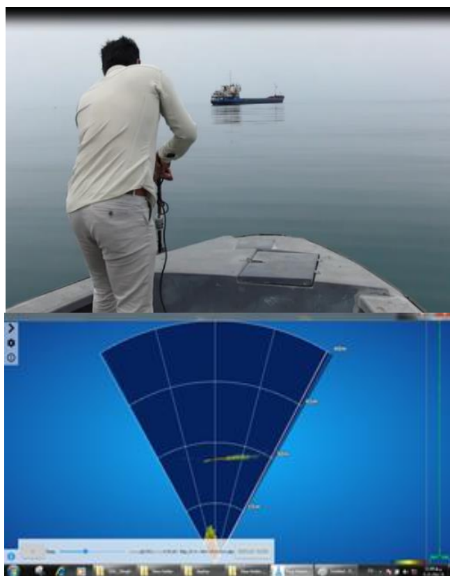
شکل ۱۳- سناریوی اخذ اطلاعات از شناور با بدنه فولادی و تصویر آکوستیکی آن
