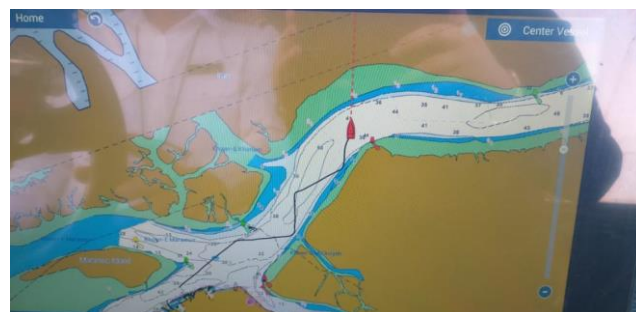
شکل ۳- تست زیگزاگ با سرعت ۱۸ گره دریایی
