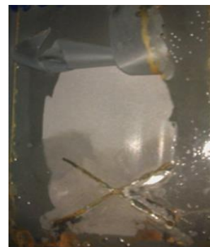
شکل ۱۴- ارزیابی سطح فلز پس از اتمام آزمایش مه نمکی و حذف لایه پوشش
