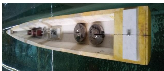
شکل ۵ - نحوه بارگذاری مدل در حوضچه کشش
