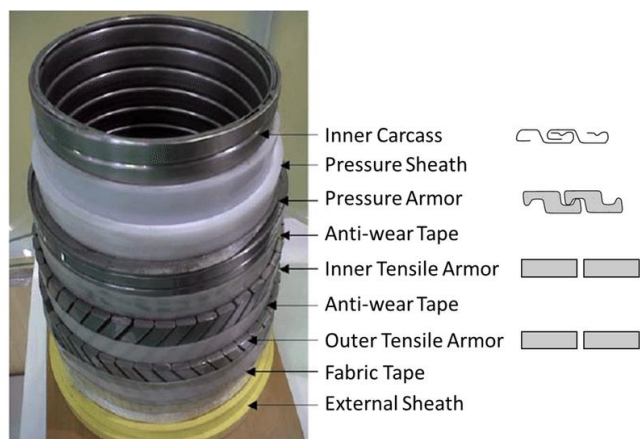
شکل ۱ لایه بندی رایزرهای انعطاف‌پذیر [۵]
